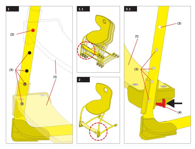
Höhenpositionen der Fußstütze (Bild 1): Mit Fußstütze (1) codierte Stühle werden mit der Fußstütze in der obersten Lochposition (2) geliefert.
