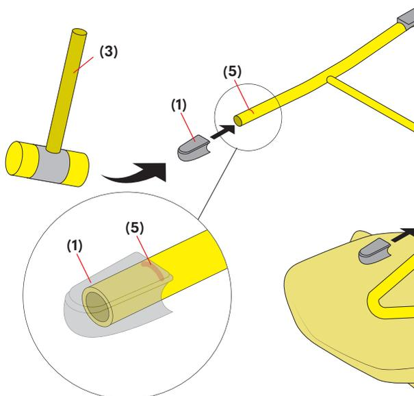
Setzen Sie dann den neuen Gleiter **(1)** am Gestellende so an, dass die Gleiteraufstandsfläche später parallel zum Boden liegt. Schlagen Sie den Gleiter mit einem Kunststoffhammer **(3)** auf das Gestell.
