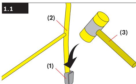
Vorhandene Gleiter **(1)** an den Gestellenden **(2)** durch einige gezielte Schläge mit einem Kunststoffhammer **(3)** auf die Gleiterkante lösen und entfernen.
