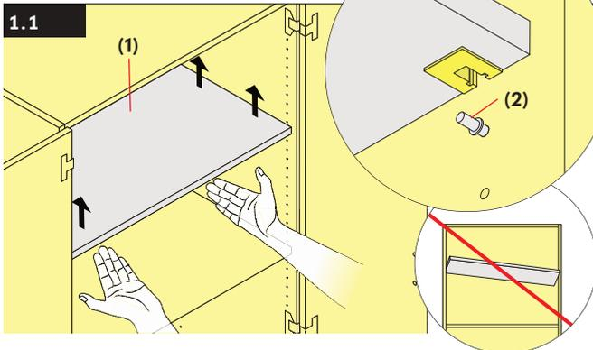
Heben Sie den Einlegeboden (1) am besten mit beiden Händen an allen vier Bodenträgern senkrecht nach oben ab und nicht verkannten, bis sich der Boden frei über den Bolzen (2) befindet. Führen Sie den Boden anschließend nach vorne aus dem Schrank.
