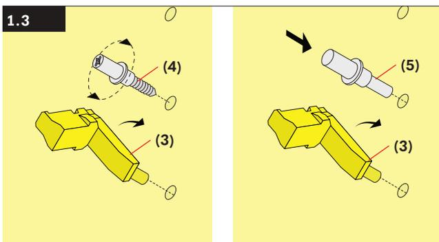
Stecken (5) bzw. schrauben (4) Sie den Bolzen auf die gewünschte Höhe in ein Reihenloch. Achten Sie darauf, den Bolzen senkrecht zur Seitenwand einzudrehen.
