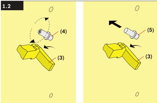
Ist eine Stütze (3) integriert, entfernen Sie diese, indem Sie sie drehen und herausziehen. Handelt es sich bei dem Bolzen um einen Schraubbolzen (4) (erkennbar am Kreuzschlitz), drehen Sie diesen mit einem Kreuzschlitzschraubendreher vorsichtig gerade heraus. Handelt es sich um einen Steckbolzen (5) (ohne Kreuzschlitz), ziehen Sie diesen gerade heraus. Benutzen Sie hierzu gegebenenfalls eine Zange.
