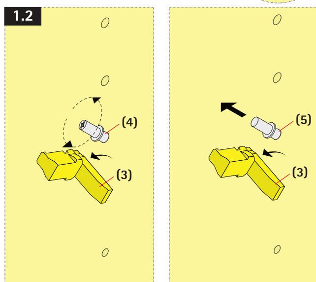
**DE** Ist eine Stütze (3) integriert, entfernen Sie diese, indem Sie sie drehen und herausziehen. Handelt es sich bei dem Bolzen um einen **Schraubbolzen (4)** (erkennbar am Kreuzschlitz), drehen Sie diesen mit einem Kreuzschlitzschraubendreher vorsichtig gerade heraus. Handelt es sich um einen **Steckbolzen (5)** (ohne Kreuzschlitz), ziehen Sie diesen gerade heraus. Benutzen Sie hierzu gegebenenfalls eine Zange.
