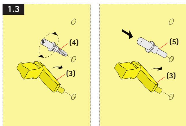
**DE** Stecken (5) bzw. schrauben (4) Sie den Bolzen auf die gewünschte Höhe in ein Reihenloch. Achten Sie darauf, den Bolzen senkrecht zur Seitenwand einzudrehen. Falls eine Stütze (3) vorhanden ist, stecken Sie diese eine Lochreihe unter dem Bolzen ein und drehen die Stütze anschließend unter den Bolzen.
