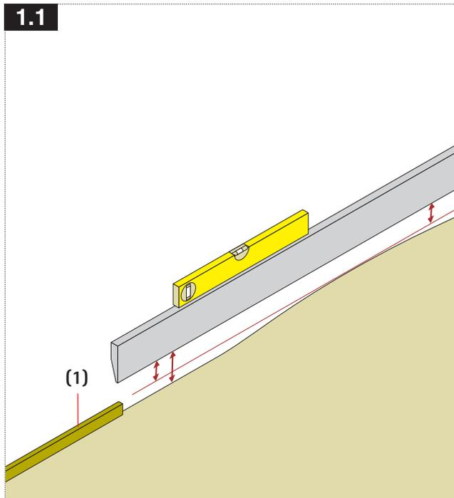
**DE** Ist eine Sockelleiste (1) vorhanden, sollte diese möglichst im Bereich der Wandpaneele entfernt werden. Wo dies nicht möglich ist, muss die Wandpaneele entsprechend höher montiert werden.
