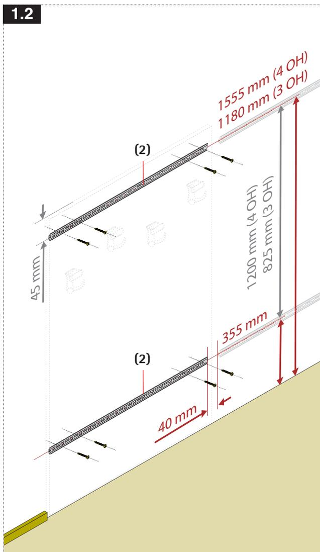
**DE** Die Wandpaneele wird mit zwei Aufhängeschienen (2) an der Wand montiert. Ohne Sockelleiste sind die beiden Aufhängeschienen in folgenden Höhen an der Wand zu befestigen (jeweils Mitte Bohrung):
