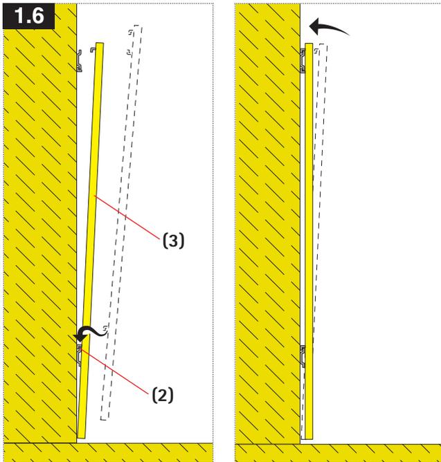
**DE** Setzen Sie dann die Wandpaneele (3) mit den beiden unteren Einhängeschlägen schräg auf die untere Aufhängeschiene (2) auf und schwenken die Paneele oben gegen die Wand ein
