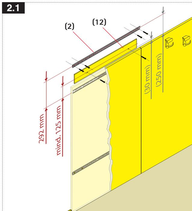
**DE** Bringen Sie Aufhängeschiene **(2)** für den Hängeschrank **292 mm** über der oberen Aufhängeschiene der Wandpaneele an (Mittelachse zu Mittelachse).
