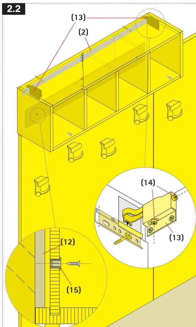
**DE** Hängen Sie den Hängeschrank mit den beiden Einhängeschlüssen **(13)** in die Aufhängeschiene **(2)** ein. Richten Sie den Hängeschrank mit den Stellschrauben **(14)** an den Einhängeschlüssen **(13)** aus. Wenn der Hängeschrank ausgerichtet ist, verschrauben Sie ihn zur Aushängesicherung durch die Buchsen **(15)** in der Rückwand mit der Dekorplatte **(12)**.
