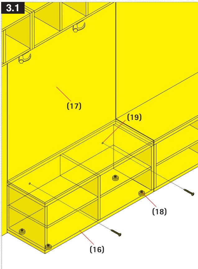
**DE** Platzieren Sie den Schuhschrank (16) vor der Wandpaneele (17) und richten Sie ihn über die vier Stellschrauben (18) am Boden aus. Verschließen Sie die Bohrungen zu den Stellschrauben mit einer Abdeckkappe.
