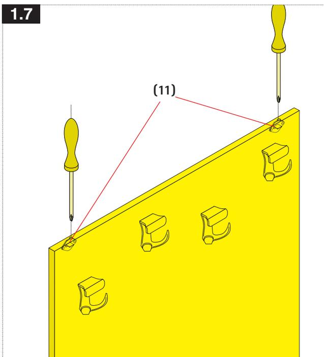
**DE** Ziehen Sie die beiden Aufhängebeschläge (11) durch die stirnseitigen Bohrungen soweit an, bis die Aufhängebeschläge die Schiene berühren. Prüfen Sie anschließend die Lage der Paneele mit der Wasserwaage und richten Sie sie gegebenenfalls über die beiden oberen Einhängeschläge aus.
