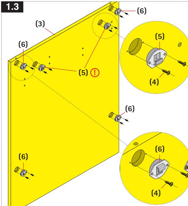
**DE** Montieren Sie die sechs Einhängeschlösser auf der Rückseite der Wandpaneele (3) mit jeweils zwei Schrauben (4).
