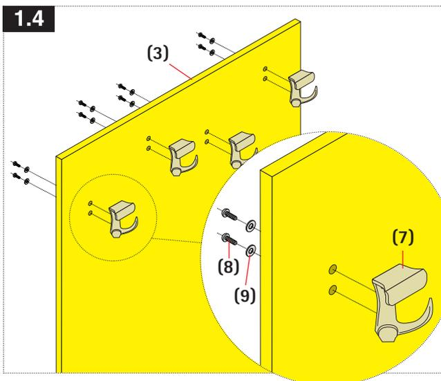
**DE** Montieren Sie anschließend die vier Kleiderhaken (7) auf der Vorderseite der Wandpaneele (3) mit jeweils zwei Schrauben (8) mit Beilagscheiben (9).
