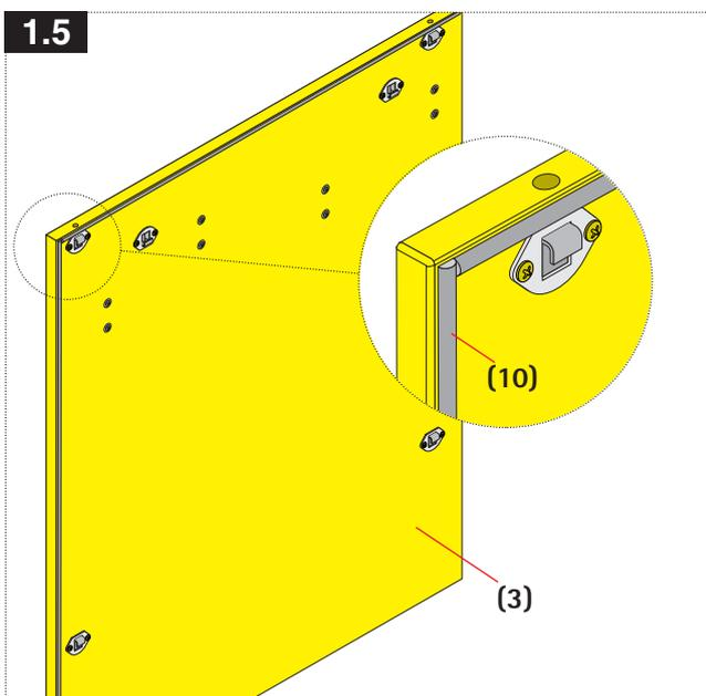
**DE** Kleben Sie auf der Rückseite der Wandpaneele (3) seitlich und oben im Abstand von 2-3 mm von der Außenkante ein selbstklebendes Dichtprofil (10) auf. Das Dichtprofil kann mit einer Feinsäge oder einer Zange auf die benötigte Länge gekürzt werden. Werden mehrere Paneele nebeneinander montiert, sind an den Stößen keine Dichtprofile erforderlich. Werden über der Wandpaneele Hängeschränke montiert, kann auch auf das Dichtprofil an der Oberkante verzichtet werden.
