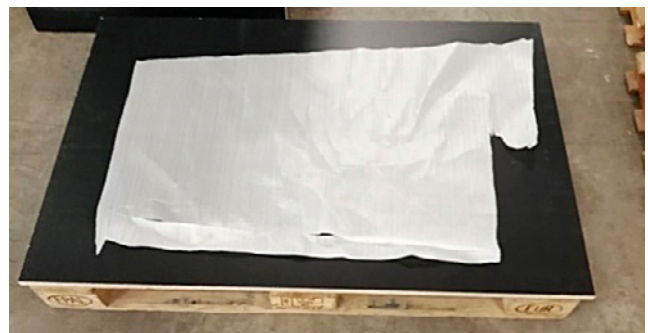
► Abb. 12.5: Schonplatte mit Schaumfolie zur Vermeidung von Beschädigungen und zur Rutschsicherung
