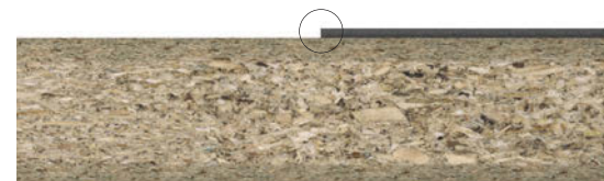
Linoleumbeschichtete Spanplatte mit angeleimter Kunststoff-/Massivholzkante (rechts) Linoleum-coated chipboard with glued-on plastic/solid wood edge (right)
