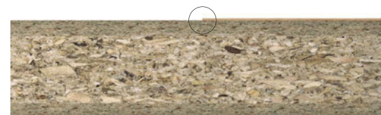
Furnierbeschichtete Spanplatte mit angeleimter Massivholzkante Veneered chipboard with glued-on solid wood edge
