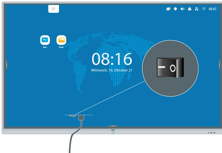
*Der Kippschalter befindet sich bei den unterschiedlichen VS-Displaymodellen an verschiedenen Stellen. Meistens an der Unterseite hinten, aber auch seitlich hinten.*
